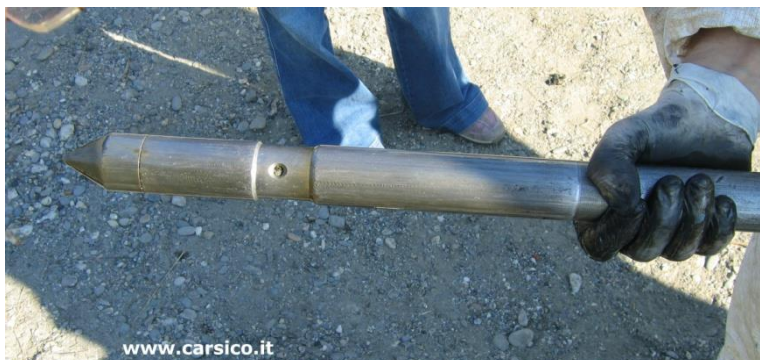
Figura 3: foto della punta dotata di fori laterali per l'iniezione dall'alto verso il basso
